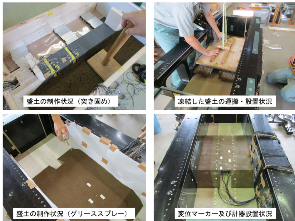
図 3.2.5 盛土の制作状況
