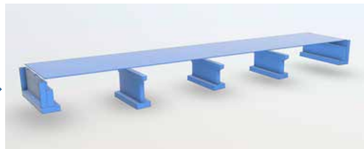
上部、下部が統合された橋梁の3次元モデル
