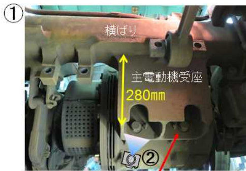
主電動機は主電動機受座にボルト4本 (上部2本、下部2本)で固定されている
