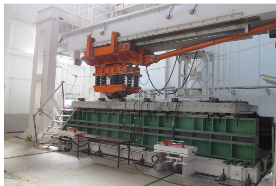
参考写真-1 接合構造の輪荷重載荷試験(大林組提供)
