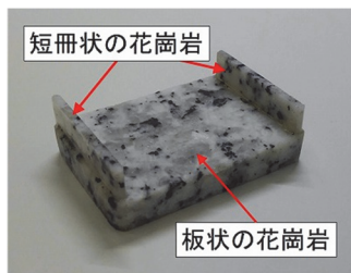
工程 1) 花崗岩を用いた台座の作製 (左: 台座の写真, 右: 横から見た模式図)
