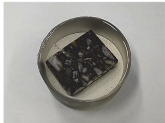
工程 2) 樹脂包埋によるアスコンの補強 (左: 樹脂包埋したアスコンの写真, 右: 横から見た模式図)
